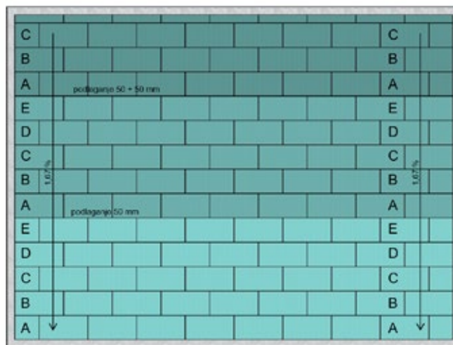
Obrázek14: Jednosměrné lineární odvodnění (např. na pultové střeše)
